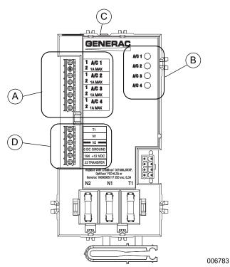
Figure 2-2. Smart A/C Module (SACM)
