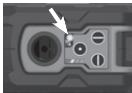
Inclinaison excessive de l'appareil
