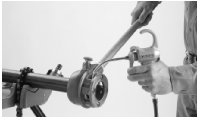
Figure 4 – Application de l'huile de coupe
