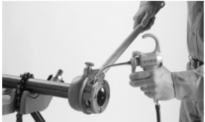
Figura 4 – Aceitado con aceite para cortar roscas
