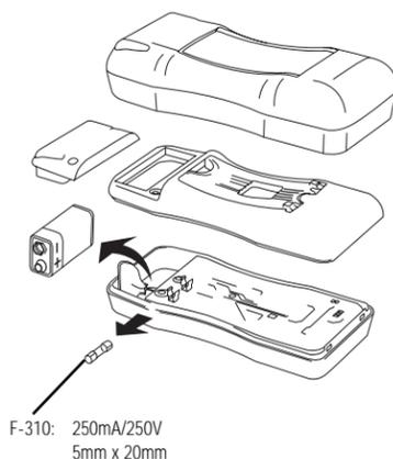
**AVERTISSEMENT :** Pour éviter l'électrocution, déconnecter les conducteurs de test avant de retirer le couvercle de pile.
