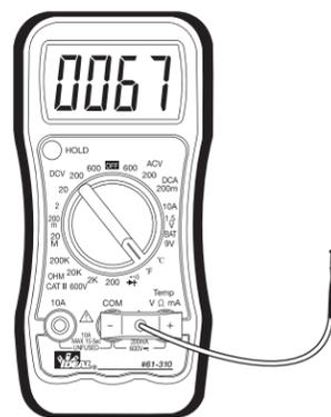
**AVERTISSEMENT :** Pour éviter l'électrocution, ne pas placer les conducteurs d'essai ou le thermocouple sur une source de tension.
