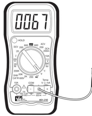
**ADVERTENCIA:** Para evitar riesgos de electrocución, no coloque los cables de prueba o la termocupla en una fuente de voltaje.
