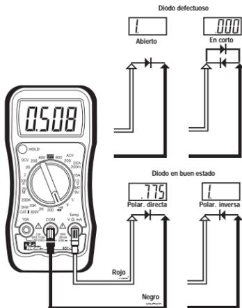
**ADVERTENCIA:** Corte la corriente en los circuitos antes de comprobar el diodo.
