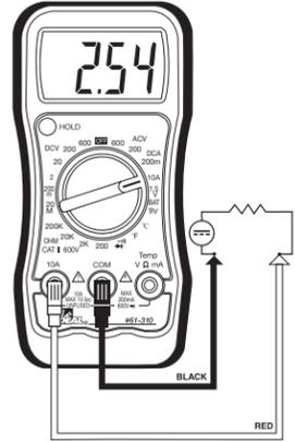
Desconecte la alimentación, inserte el instrumento en serie y vuelva a conectar.
