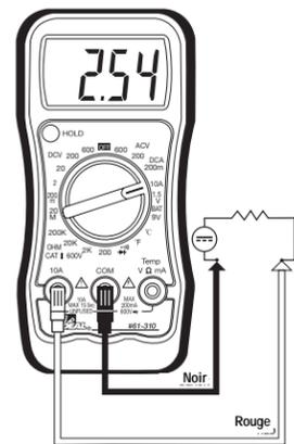
Couper l'alimentation, disjoncter le circuit, connecter le multimètre en série, puis rétablir l'alimentation.
