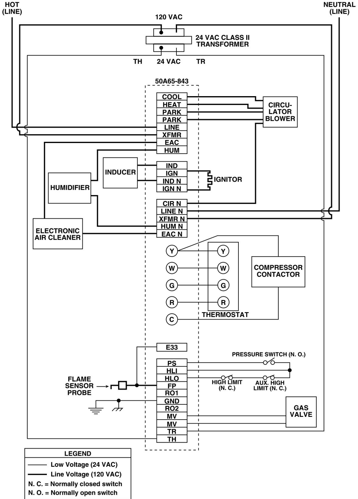
**TYPICAL SYSTEM WIRING TABLE**
